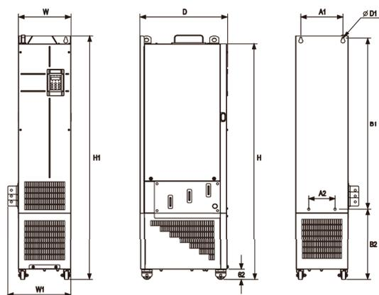
MD500T200G~MD500T450G 外型尺寸及安装尺寸示意图（不带电抗器底座）
